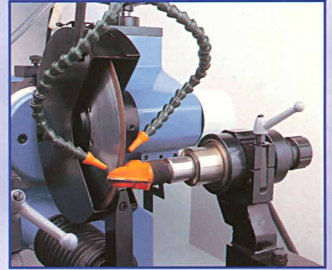
Profilatura punte da pantografo Routerbit profiling Affutage des meches de défonceuse Profilierung von Profilschaftfräsers
