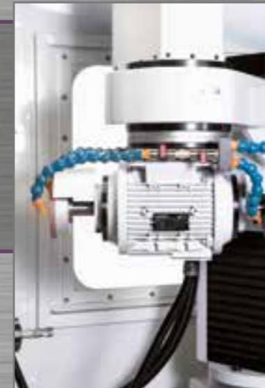
Axe rotatif de la meule avec moteur brushless: en option on peut livrer la machine en 4 axes avec inclinaison manuelle de la meule.
