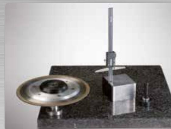
Dispositivo micrometrico di presetting, permette una accurata messa a punto e controllo della mola.
