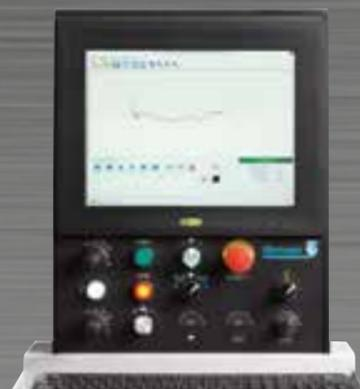
Pannello di controllo con PC e software Windows completo di comandi di facile lettura con menu guidato per una semplice introduzione dei dati dell'utensile e la successiva piazzatura.
