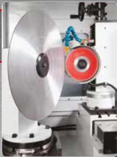
Affilatura con mola tangenziale. Peripherie-Schleifscheibe.
