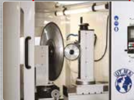
AC 800 Schleifung von Rundmesser bis Durchmesser 800 mm
