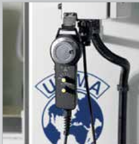
Manivelle électronique pour un positionnement manuel précis de l'axe sélectionné. Volante electrónico para un posicionamiento manual del eje seleccionado.
