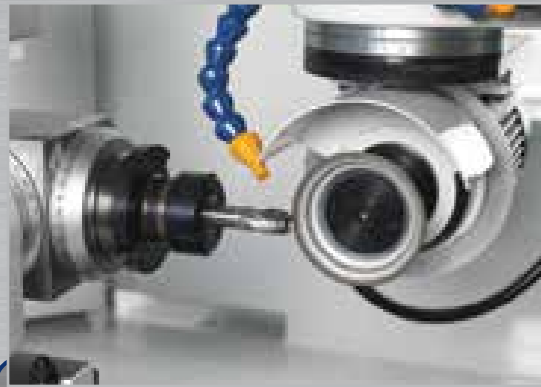
Affutage extérieur d'une mèche hélicoïdale. Afilado externo de una fresa helicoidal.
