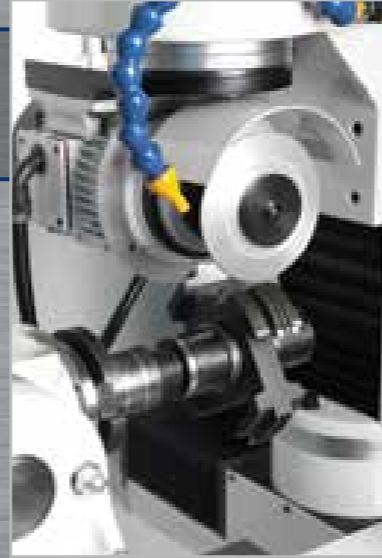
Dispositif de relevé du pas de l'hélice et d'autres paramètres de l'outil Palpador para identificación del paso de la hélice y otros parámetros de las herramientas.
