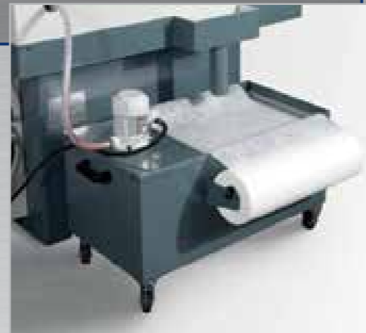
Bac d'arrosage avec filtre à papier. Depósito de refrigerante con filtro de papel.
