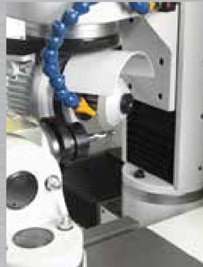
Affutage de la goujure d'une mèche hélicoïdale. Afilado de la ranura de una fresa helicoidal.
