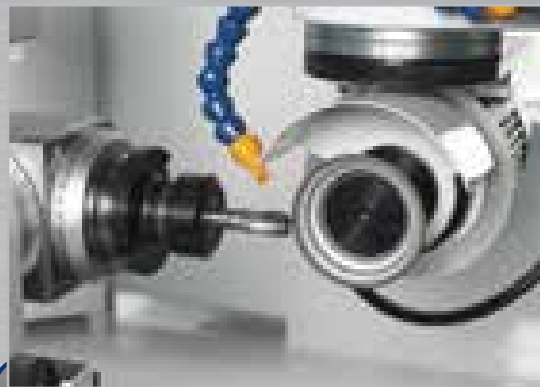
Affilatura esterna di una fresa elicoidale. Aussenschleifung einer Spiralfräser.
